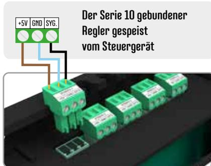
Anschluss der Zwei-Punkt-Regler mit L-10 Schiene
