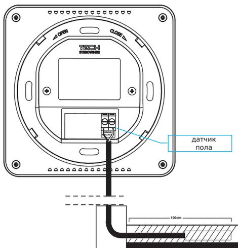
На схеме ниже показана сборка отдельных частей регулятора:
